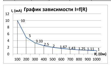
Вывод: произвели теоретические расчёты и экспериментально убедились в выполнении закона Ома для электрической цепи. Погрешность рассчитанных и экспериментальных данных обусловлена возможной неточностью приборов,
